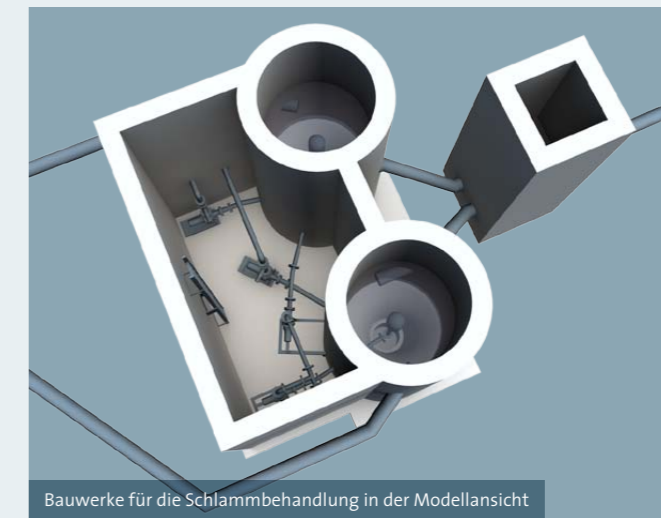
Schlammumpwerk mit Rücklaufschlamm- und Überschussschlammwerk
